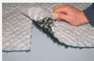
Geringes Rollengewicht (links), sichere Überlappung (rechts)
